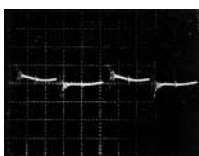
無信号時 V : 20mV / Div H : 2μS / Div
